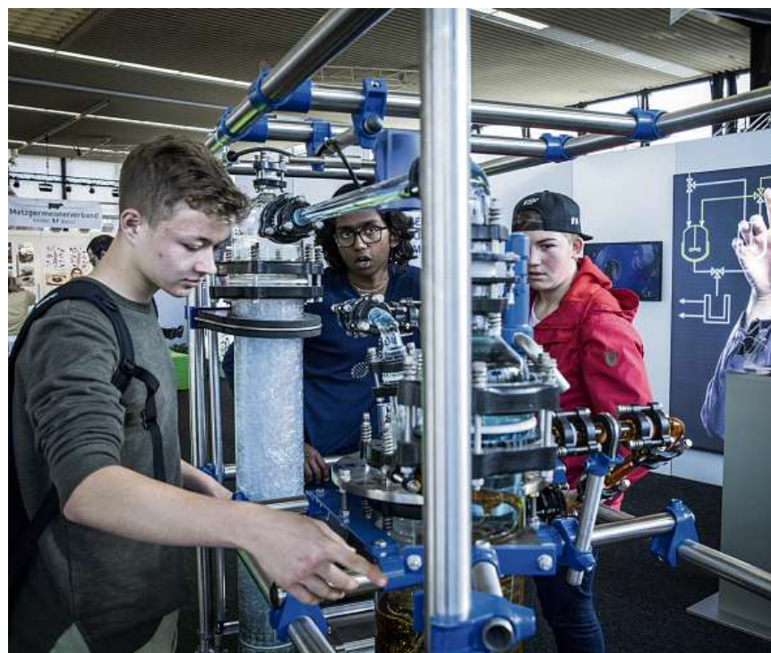
Spektakuläre Maschinen. Lehrling Charangan Balakumar (Mitte) präsentiert voller Stolz einen Spiralwärmetauscher und Absorber und wirbt mit diesem blubbernden Apparat für die Lehren in der Chemie- und Pharmabranche.
